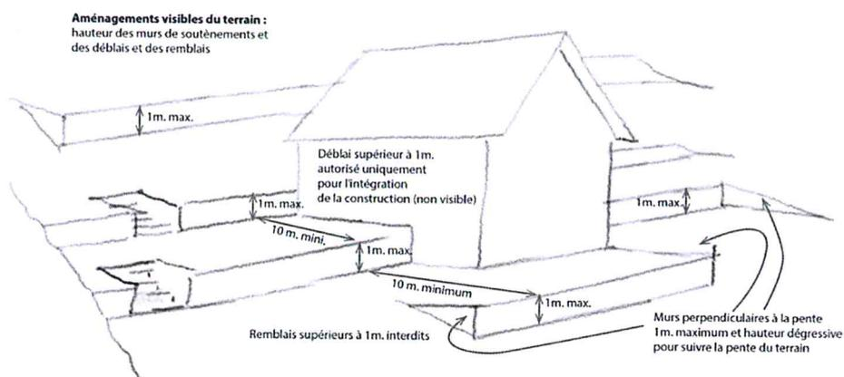
Une distance de 10 m doit être maintenue entre deux murs de soutènement.
